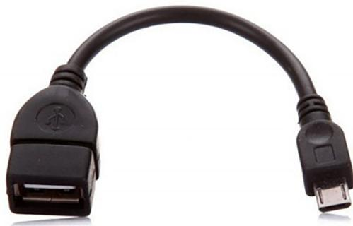
Abbildung 3. USB-OTG-Kabel
